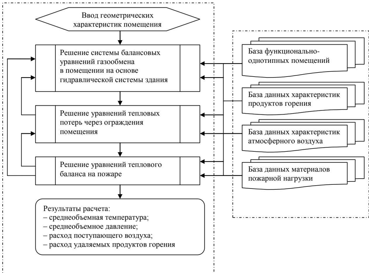
Рис. 2. Алгоритм расчета параметров состояния термодинамической системы на внутреннем пожаре
