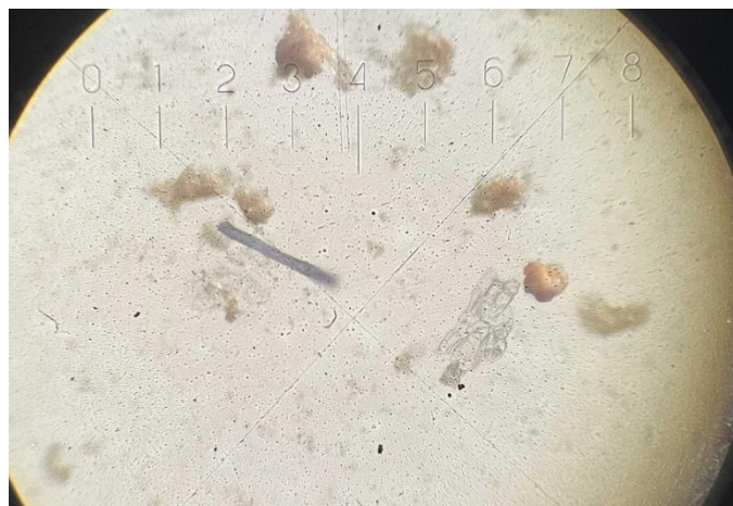
Рис. 10. Проба №4. Микропластик прозрачный волокнистой формы
