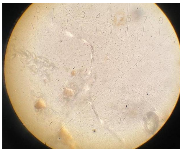
Рис. 6. Проба № 6. Микропластик прозрачный волокнистой формы
