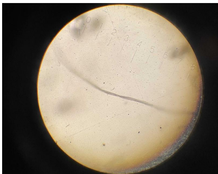
Рис. 2. Проба № 7. Микропластик волокнистой формы прозрачного цвета
