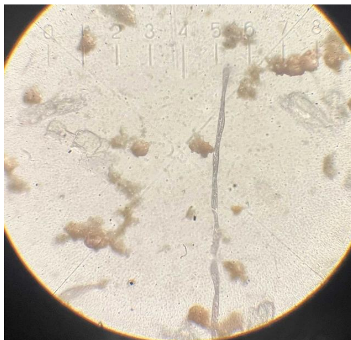
Рис. 12. Проба № 3. Микропластик прозрачный волокнистой формы
