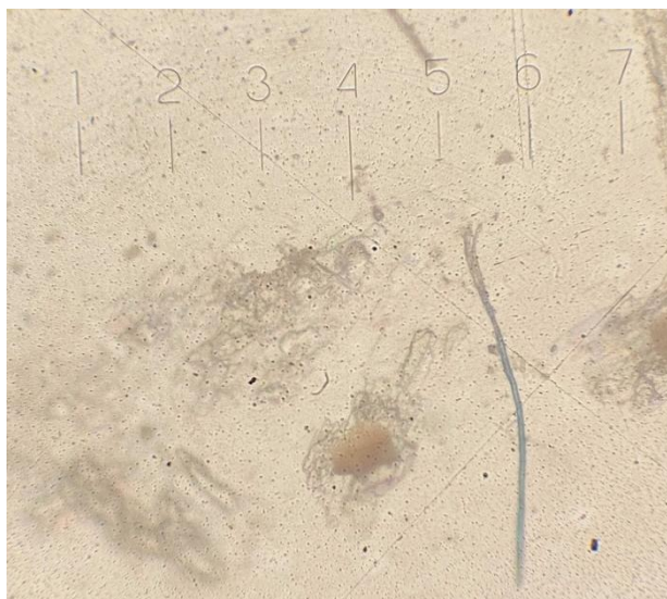
Рис. 4. Проба № 7. Микропластик волокнистой формы синего цвета
