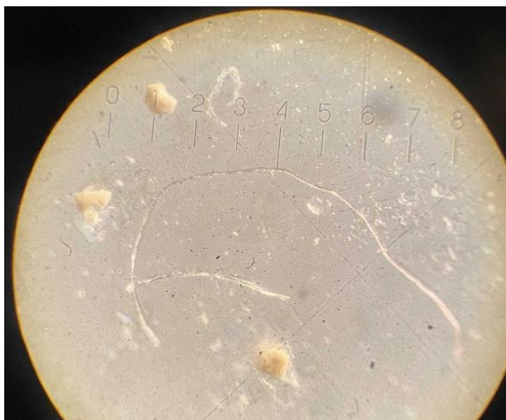
Рис. 3. Проба № 7. Микропластик волокнистой формы прозрачного цвета
