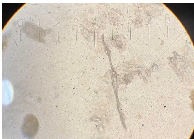
Рис. 9. Проба № 4. Микропластик прозрачный волокнистой формы
