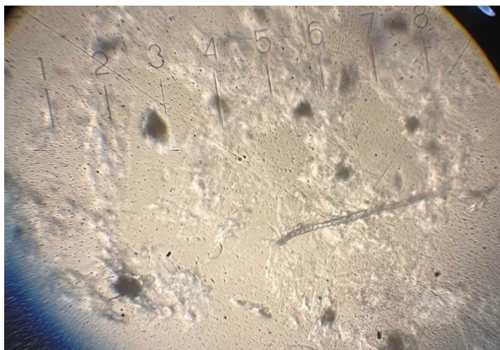
Рис. 1. Проба № 7. Микропластик волокнистой формы прозрачного цвета
