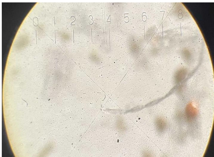
Рис. 13. Проба № 3. Микропластик прозрачный волокнистой формы
