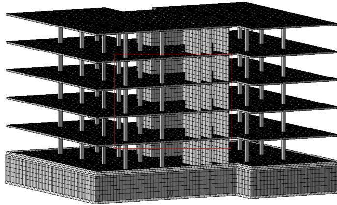
Рис. 5. Расчетная схема монолитного здания
