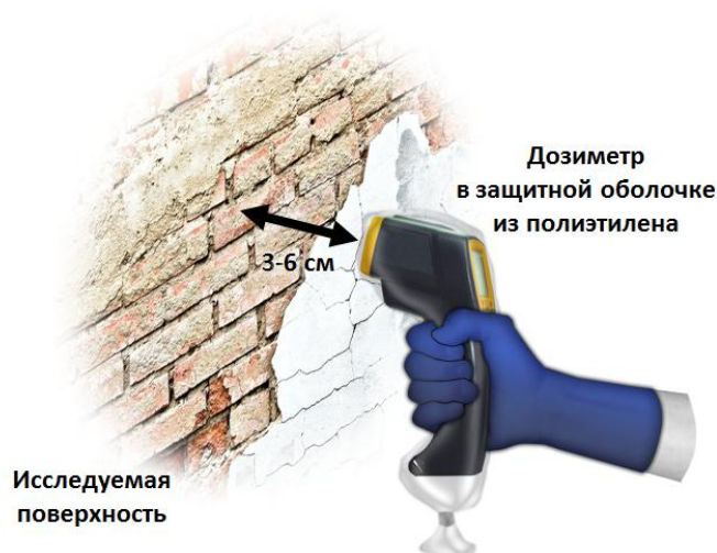
Рис. 3. Рекомендуемый МАГАТЭ способ обращения с датчиком при определении загрязнения поверхности [6]
