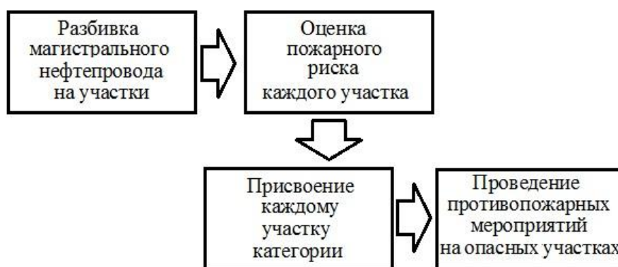
Рис. 2. Структурная схема методики категорирования участков линейной части МН на основе оценки пожарного риска
