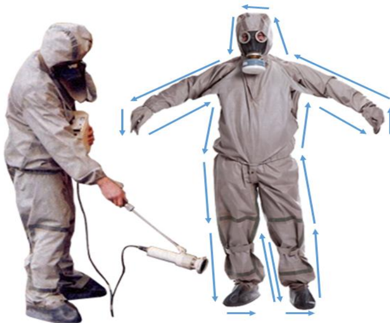
Рис. 5. Последовательность измерений уровня загрязнения
