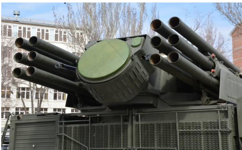
Рис. 6. Вооружение комплекса «Панцирь-С1». В центре РЛС сопровождения, по бокам от нее 30-мм пушки и контейнеры (пустые) управляемых ракет
