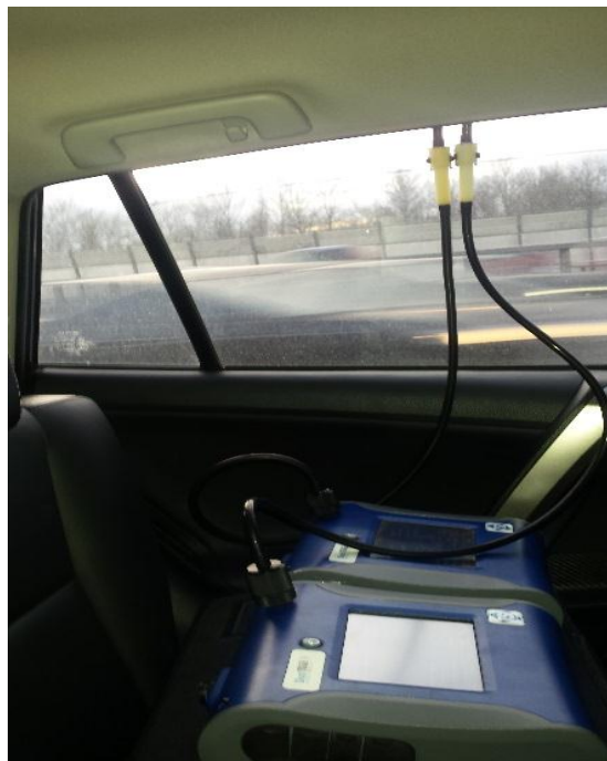
Рис. 1. Процесс измерения концентраций взвешенных частиц PM_{10} и PM_{2,5} в воздушной среде на КАД Санкт-Петербурга
