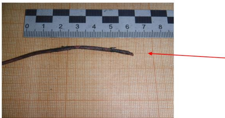
Рис. 4. Оплавление объекта № 6 (отражено стрелкой)
