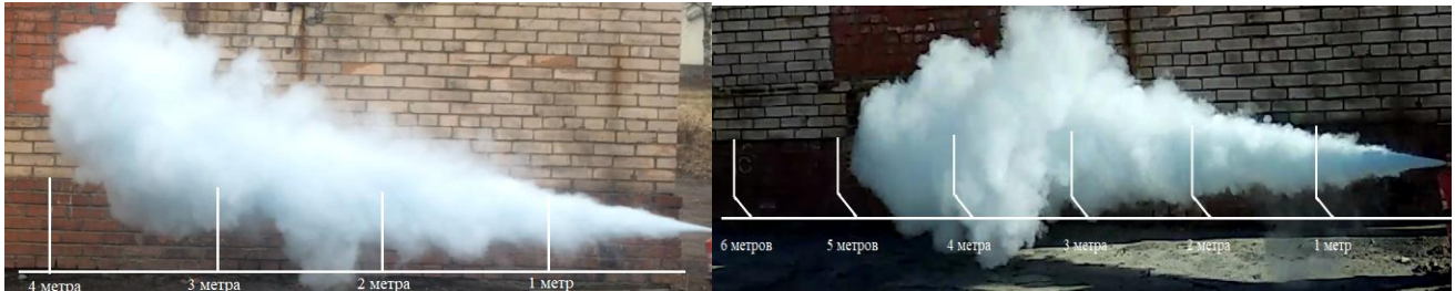
а) распределение облака ОПС на длину не менее 4 м при заряде массой 1 кг для экспериментальной модели порошкового огнетушителя ОП-1э
