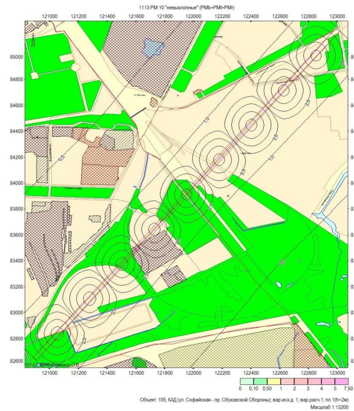
Рис. 3. Прогноз загрязнения придорожного воздуха на КАД СПб на участке от ул. Софийской до пр. Обуховской Обороны опасными частицами PM_{10} : а) суммарно; б) «взрывными»; в) «невзрывными» при неблагоприятных метеорологических условиях и высокой интенсивности движения
