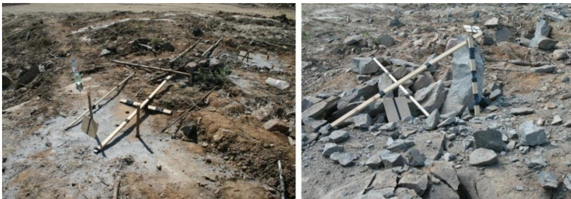
Рис. 4. Общий вид площадки и результаты взрывов: а) аммонит А1 и А2; б) геляпор Г2
