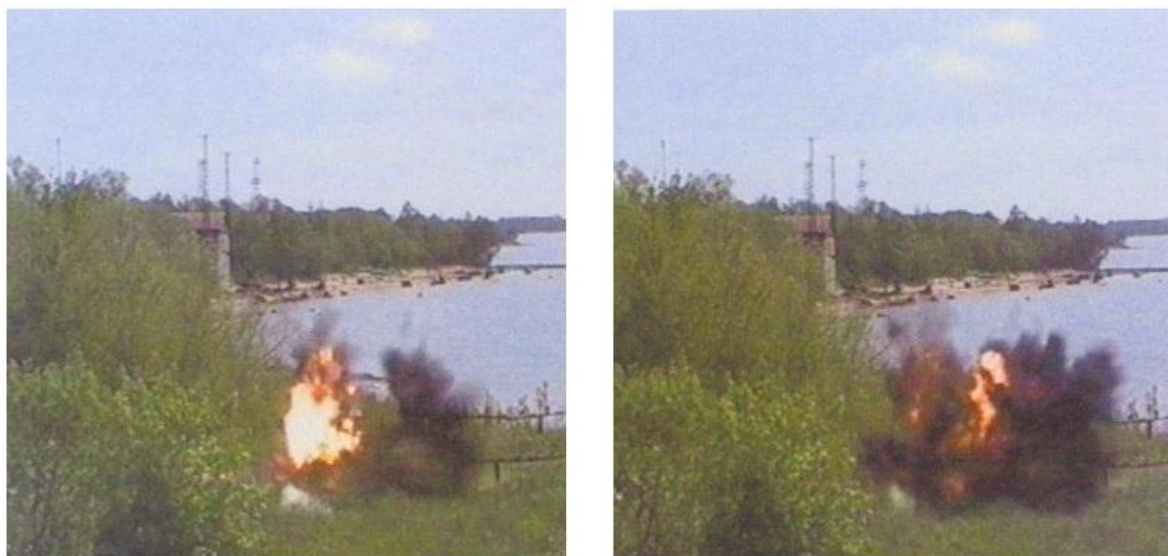
Рис. 3. Видеogramмы взрывов зарядов ТНТ и геляпора
