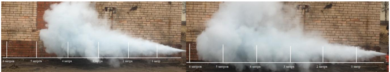
б) распределение облака ОПС на длину не менее 5 м при заряде массой 2 кг для экспериментальной модели порошкового огнетушителя ОП-2э
