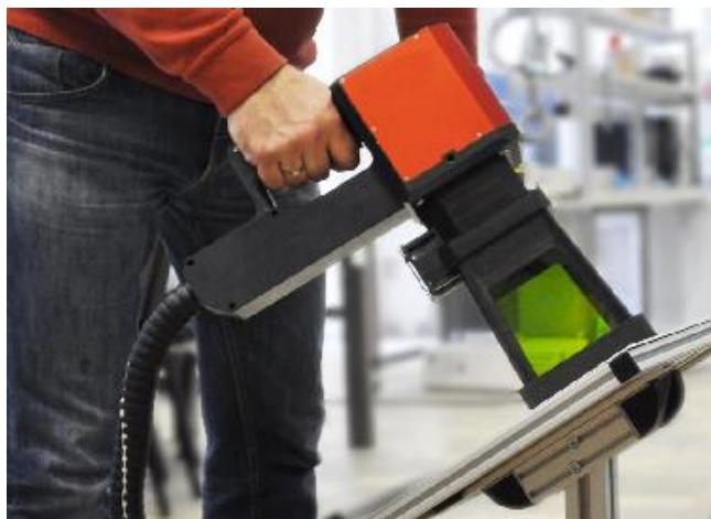
Рис. 1. Нанесение штрих-кода лазерным гравером на металлоконструкцию изделия
