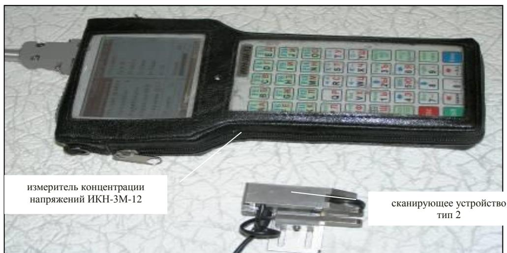
Рис. 1. Измеритель концентрации напряжений ИКН-3М-12 и сканирующее устройство – тип 2
