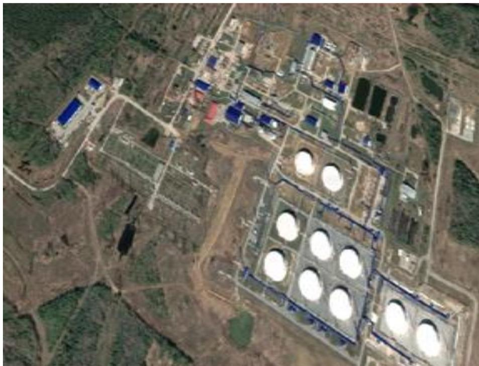
Рис. 3. Размещение РВС на территории типовой нефтебазы
