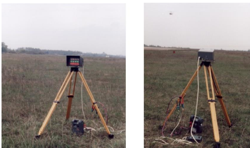
Рис. 3. Мобильный глиссадный маяк АЕРУ.461523.002 НТП «Аэрооптика» во время проведения летных испытаний
