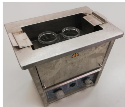
Рис. 2. Обработка ультразвуком в ультразвуковой ванне
