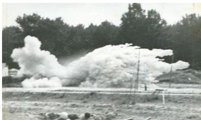
Рис. 4. Начальная стадия залпа из девяти стволов, распыляющих 180 кг порошка на дальность до 150 м с площадью тушения до 850 м 2
