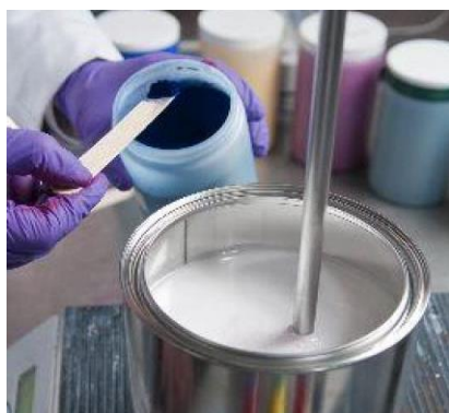
Рис. 1. Процесс получения суспензии порошкообразных модификаторов и отвердителя с использованием турбинных мешалок
