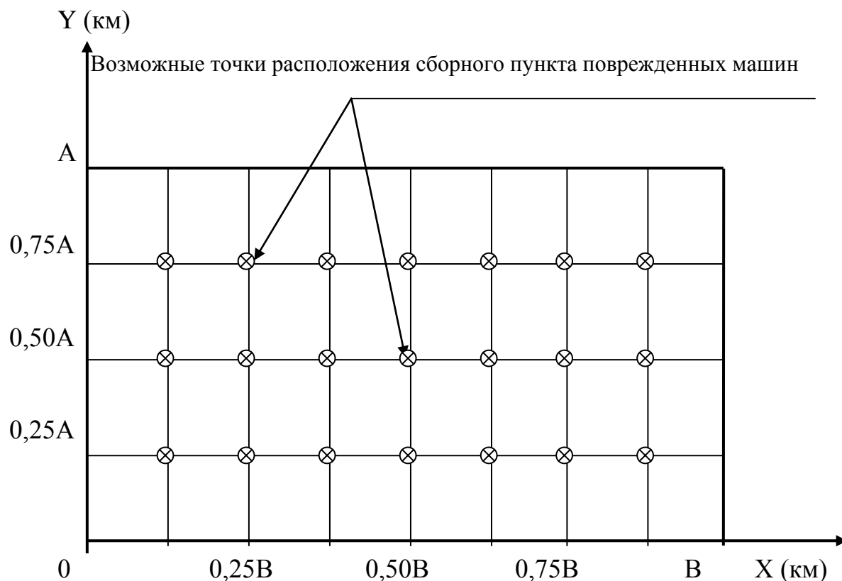
Рис. 1. Расчетная схема выбора координат расположения сборного пункта поврежденных машин
