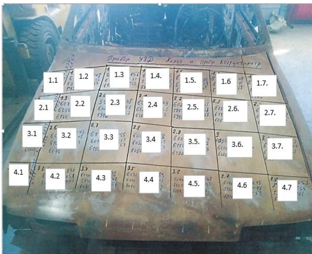
Рис. 1. Схема точек замера силы тока размагничивания
